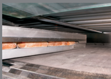
▶ Inserimento del telaio nella camera
